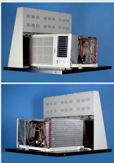
La composición principal de KR-201 es un aire acondicionado real de tipo ventana, como los que se usan en el día de hoy. Este sistema permite al estudiante observar la operación interna del componente y el estado de refrigerante cuando el aire acondicionado está en funcionamiento.
