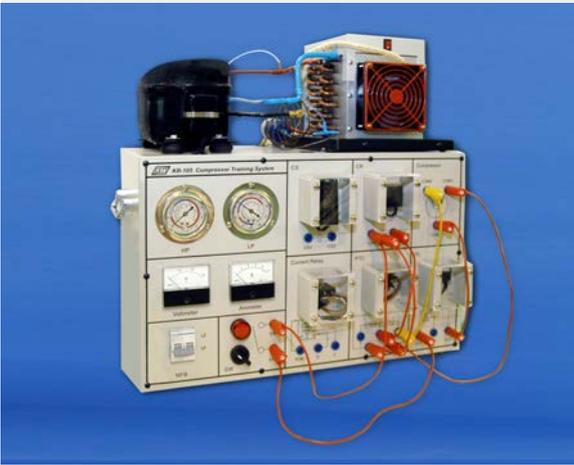
El estudiante puede cablear el circuito de compresor personalmente utilizando el KR-105. Este sistema de entrenamiento proporciona dos métodos de inicio (modo de corriente y PTC). El estudiante puede medir y observar las señales de los terminales en el inicio de circuito para comprender el principio de operación. Además, el equipo consiste en un sistema de refrigeración real, por lo tanto, cuando el cableado esté completo y se inicia el circuito, se conduce al compresor real.
