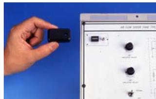
Todos los módulos están equipados con interruptor DIP de 4/8 bits para simulación de fallas
