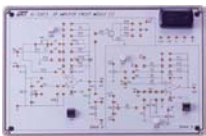
KL-23013 Circuito de amplificador OP (1)
